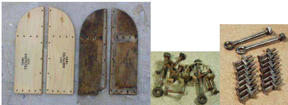
Plaques de jonction et leur visserie avant et après restauration
