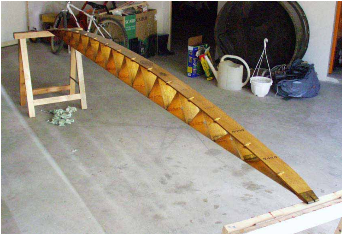
Longeron canard nettoyé, verni, prêt à l'assemblage
