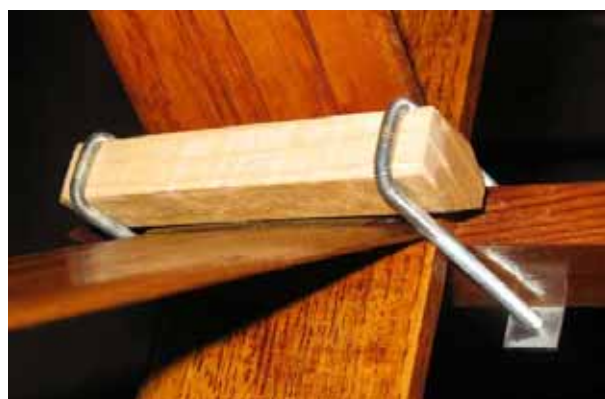
Bride de liaison nervure - longeron.
