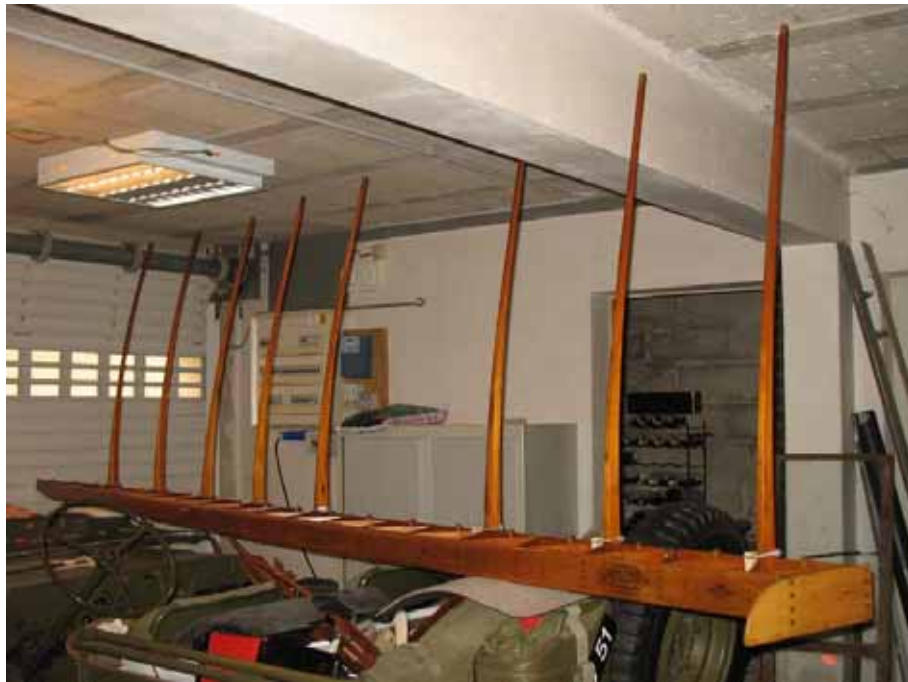
Aile droite en cours d'assemblage
