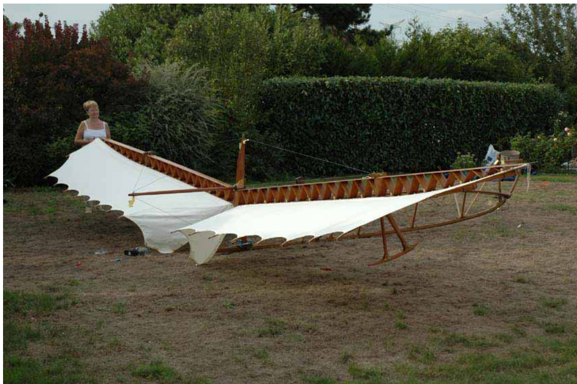
Le 2 septembre 2010. Vérification de l'installation du plan principal
